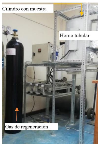
Figura 3. Sistema de regeneración del método TSA-PSA
