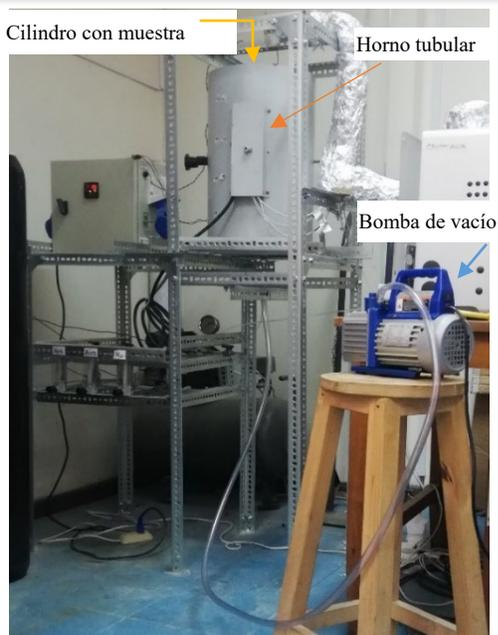
Figura 2. Sistema del reactor para el método TSA-VSA
