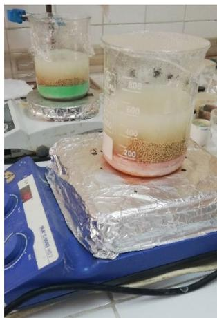
Figura 4. Sistema de intercambio iónico de zeolita
